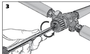
Клапан предварительно настроен на температуру 40 °С при входящей горячей воде 70 °С и входящей холодной воде 15 °С.
