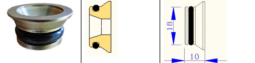
Адаптер применяется для присоединения к коллектору или радиаторному клапану стандарта «евроконус» соединителей с плоской прокладкой (например: гибкой подводки или фитингов VTm.222 16x3/4).
