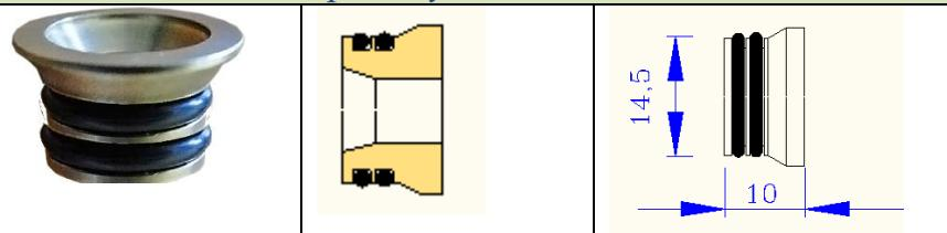
Адаптер применяется для присоединения к коллектору или радиаторному клапану стандарта «конус» соединителей с плоской прокладкой (например: гибкой подводки или фитингов VTm.222 16x1/2).
